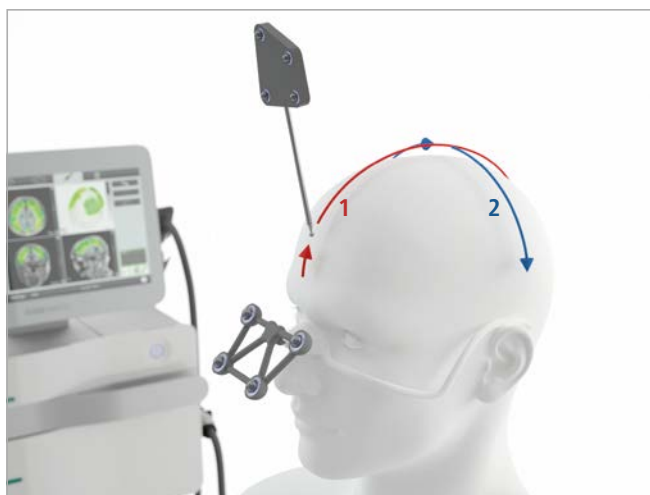
Étalonnage effectué manuellement : étapes 1 (rouge) et 2 (bleu)
